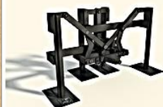
Стопоходящая машина. Железная модель
